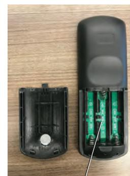
Schéma de la polarité à l'intérieur du compartiment des piles
