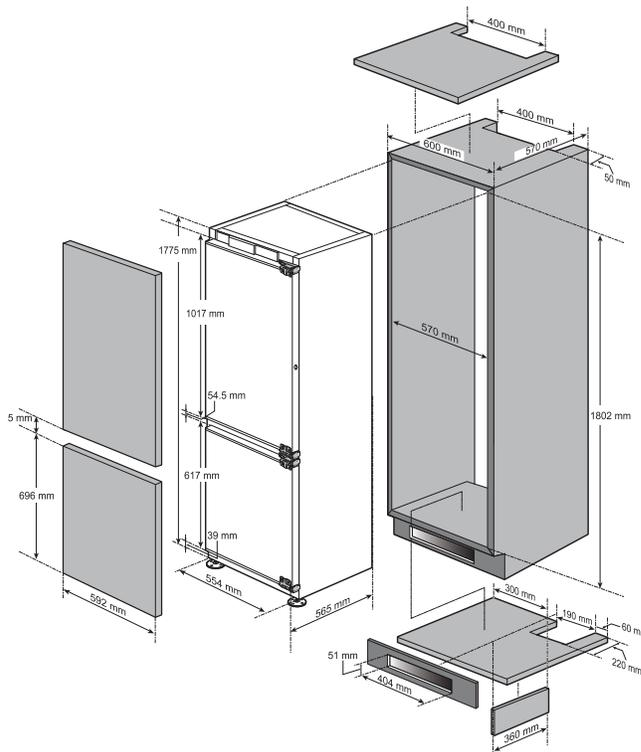
• Les dimensions des panneaux de porte sont modifiées en cas de changement d'épaisseur du matériau de l'armoire.
